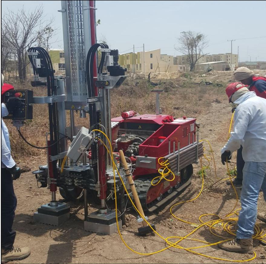
**Obsérvese Martillo que genera por impacto ondas elásticas, para luego ser captadas en profundidad por dos acelerómetros conectados en el equipo sísmico. (Ver equipo realizando la prueba SCPTu, dentro del lote de Villa San Pablo).**
