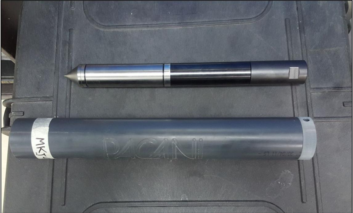
**Figura 3.2. Cono eléctrico utilizado en los sondeos por método indirecto en campo piezocono (CPTu). Fuente: Elaboración propia.**
